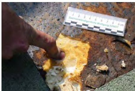
Abbildung 07 (links): Oberseite einer mineralkaschierten PU-Dämmstoffplatte. Durch Fingerdruck wird Wasser herausgepresst.
