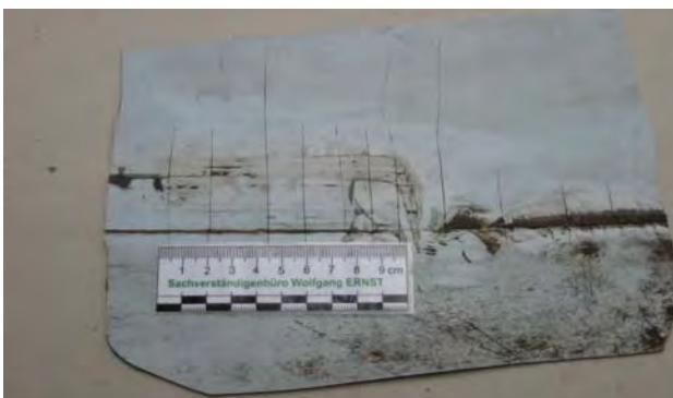
Abbildung 15: Ende einer Automaten-schweißnaht bei einer PVC-Bahn mit Übergang zur Handschweißnaht nach der Entfernung der überlappenden Bahn.
