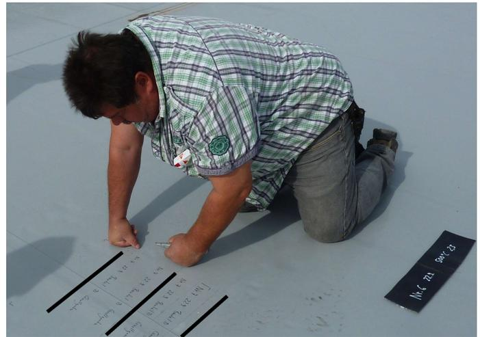
Abbildung 7: Nahtprobenentnahme zur Schälzugprüfung im Rahmen einer qualitätszertifizierten Ausführungsüberwachung.
