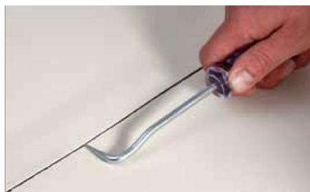
Abbildung 02: Nahtkontrolle mit Prüfnadel.
